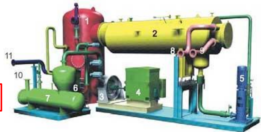
Abb. 3.3/2 Grafische Darstellung eines 1 MW ALDAVIA ORC-Moduls
